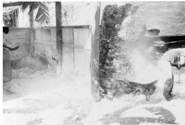
Figure 7. Le déchargement du four s'effectue à l'aide d'une pelle et d'une brouette, la chaux est ensuite placée dans l'abri attendant au four.
