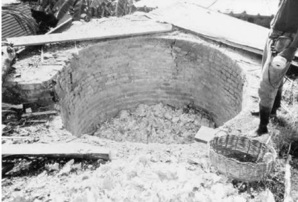
Figure 6. Le chargement du four une fois les coquilles consommées
