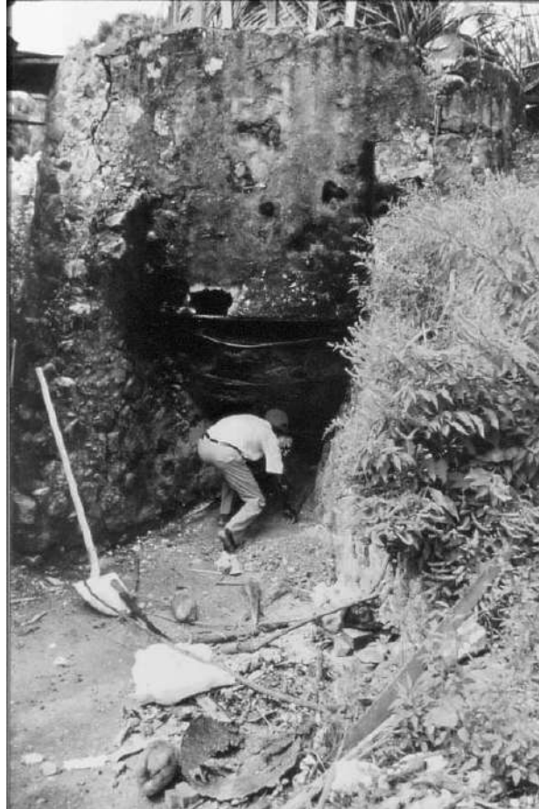
Figure 5. Allumage du four au moyen de bûchettes de bois disposées sous le treillis
